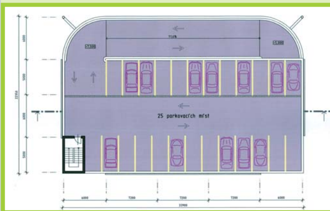
Jeden z průřezů podlažím.
