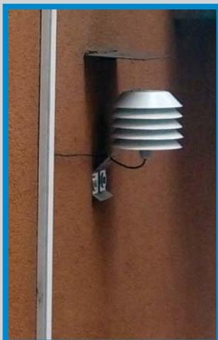
Interval záznamu dat z teplotního čidla je 10 minut, takže měření poskytuje detailní přehled o průběhu teplot během dne. Zvolená měřicí technika a provedení instalace odpovídá standar-
