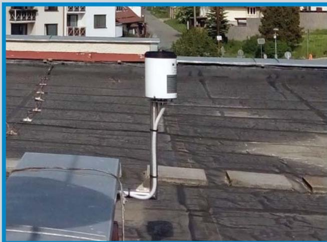
při měření dešťových srážek, v rámci protipovodňové ochrany. Při překročení limitních srážek systém zasílá výstražné SMS zprávy členům povodňové komise a dotčeným starostům níže po toku Lutoninky a varuje tak před bleskovými povodněmi.
